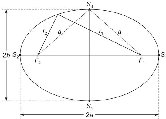
**Abb. 1** Ellipsen-Gärtnerkonstruktion mit  $r_1 + r_2 = 2a$ .
