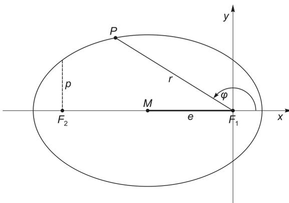
**Abb. 3** Ellipsenbrennpunktlage in  $F_1$ .  $r$  ist hier die Länge des sog. Fahrstrahls.
