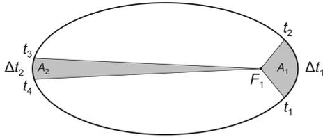
**Abb. 6** Flächensatz:  $\Delta t_1 = \Delta t_2 \Leftrightarrow A_1 = A_2$ . Daraus wird ersichtlich: Im Perihel (Scheitel  $S_1$ ) hat die Bahngeschwindigkeit ihr Maximum und im Aphel (Scheitel  $S_2$ ) ihr Minimum.
