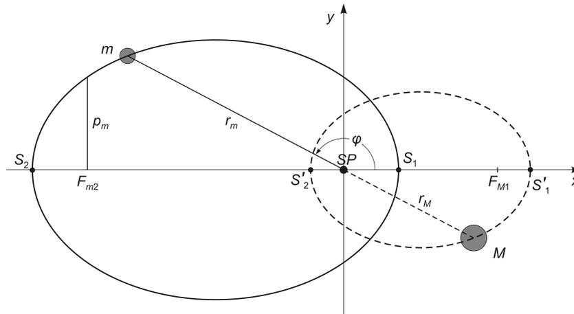
**Abb. 8** Zweikörperproblem als Schwerpunktsystem: Der gemeinsame Schwerpunkt  $SP$  der Punktmassen  $M$  und  $m$  wurde in den Ursprung des  $(x, y)$ -Koordinatensystems gelegt. Die Strecke  $r_M + r_m = r$  zwischen  $M$  und  $m$  verläuft stets durch  $SP$  und folglich im Schwerpunktsystem durch den Koordinatenursprung.
