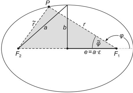
**Abb. 4** Gemäß der Gärtnerkonstruktion von Ellipsen gilt hier  $r + \tilde{r} = 2a$ . Die Länge der Basis des grau hinterlegten Dreiecks beträgt  $2 \cdot e = 2 \cdot a\varepsilon$ .
