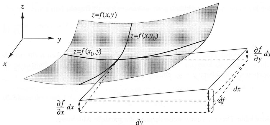
**Abb. 9** Graphische Veranschaulichung des totalen Differentials der Funktion  $f(x, y) = z$ . Die Funktionwerte  $z$  bilden die punktierte gekrümmte Fläche über der  $(x, y)$ -Koordinatenebene. „Das totale Differential (49) ist die Gleichung für die Tangentialebene im Punkt  $(x, y, z = f(x, y))$ .“ Zitat (in Anführungszeichen gesetzt) und Abbildung aus dem Hochschultaschenbuch von Christian B. Lang und Norbert Pucker, Spektrum Akademischer Verlag, Heidelberg, Berlin, 1998, Seite 84.
