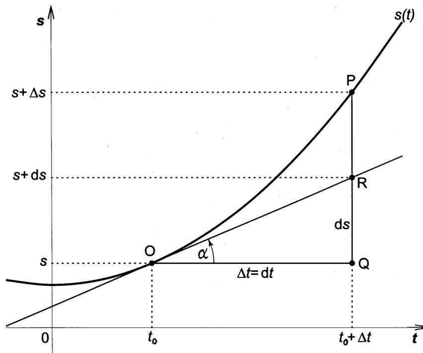
**Abb. 1** Geometrische Veranschaulichung der Differenziale  $ds$  und  $dt$  sowie des Differentialquotienten  $ds/dt = \tan \alpha$  im Punkt  $s(t_0)$  der Funktion  $s(t)$ .
