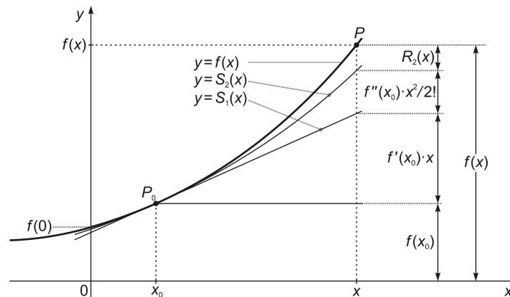
**Bild 23.4** Zweite Form der Taylor'schen Reihe, d. h. Taylor-Entwicklung der Funktion  $f(x)$  an der (Entwicklungs-)Stelle  $x = x_0$ . (nach H. Nickel und Mitarbeiter, 1983)
