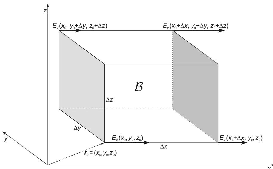
**Abb. 14** Darstellung des Flusses der  $E_x$ -Komponente des Vektorfeldes  $\vec{E}(\vec{r})$  durch den quaderförmigen Raumbereich  $\mathcal{B}$ .
